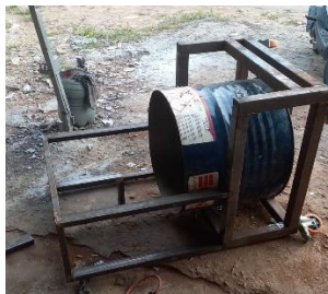
Gambar 3. 43 Proses Penguncian Drum Pada Rangka Sumber: Dokumentasi Pribadi 2026
