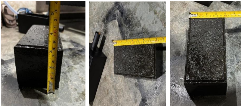
Gambar 4. 10 Detail Dimensi Aktual Produk Eco Paving
