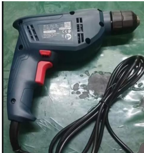
Gambar 3. 5 Bor Listrik Sumber: Dokumentasi Pribadi 2026
