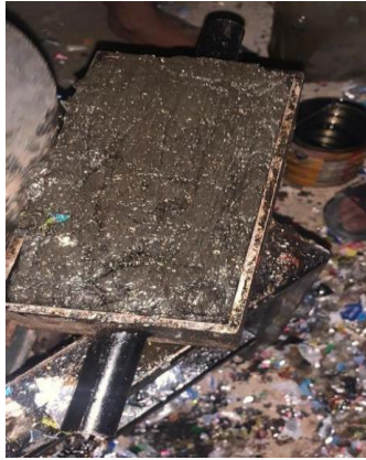
Gambar 4. 6 Proses Pencetakan Eco Paving Blok
