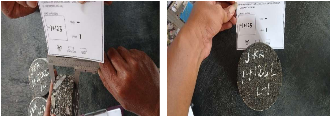
Gambar 4. 4 Pengukuran Sampel Hasil Core Drill (Sumber : Dokumentasi Proyek)
