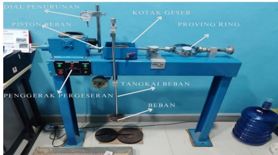
Gambar 3. 3 Alat uji geser langsung
