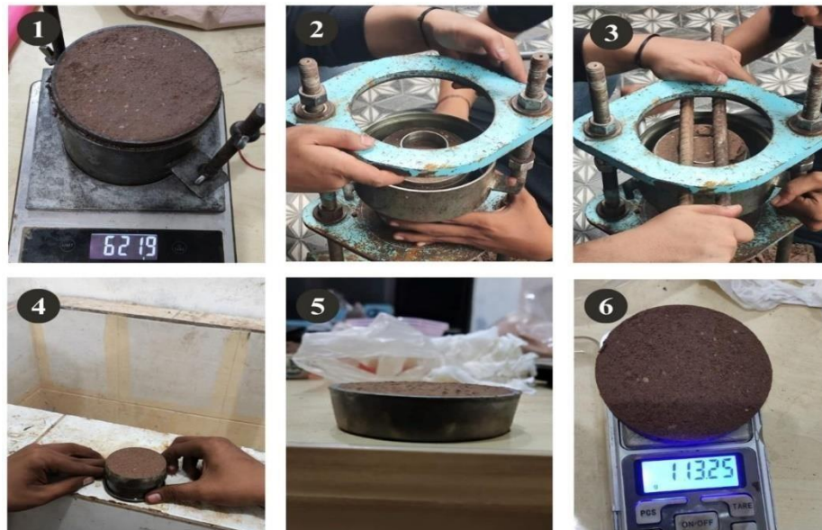
Gambar 3. 2 Proses Pembuatan sampel uji geser (Dokumentasi Pribadi, 2026)
