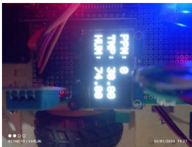
Gambar 4.2 Direct Pembacaan Suhu dan Gas Pada LCD OLED
