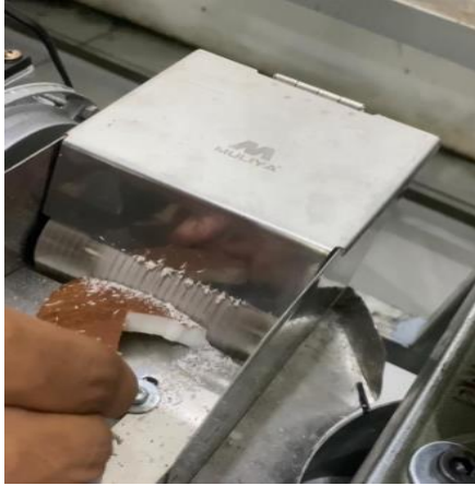
Gambar 5. Hasil proses pamarutan kelapa
