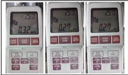
Gambar 14. Hasil Pengukuran Kekasaran Permukaan 1400rpm
