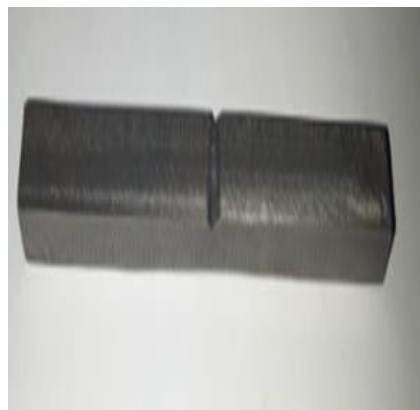
Gambar 11. Benda uji (Baja SKD 61)
