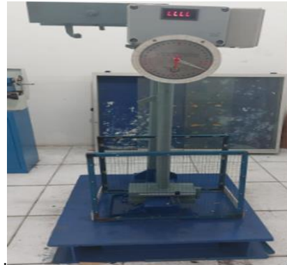
Gambar 1. Alat Uji Impact
