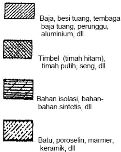
Gambar 30. Contoh arsiran untuk material berbeda
