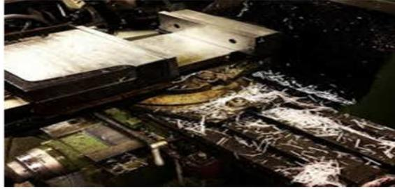
Gambar 46. Kondisi kotor pada mesin milling
