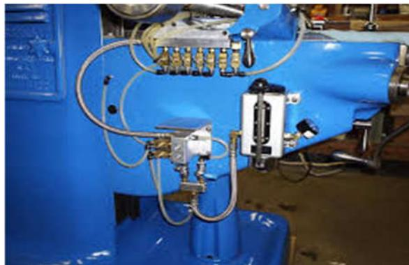
Gambar 45. Oli pelumas mesin milling
