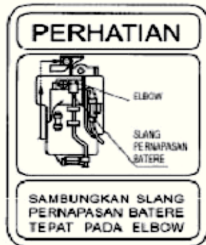
Gambar 20. Memeriksa Pipa Ventilasi Baterai
