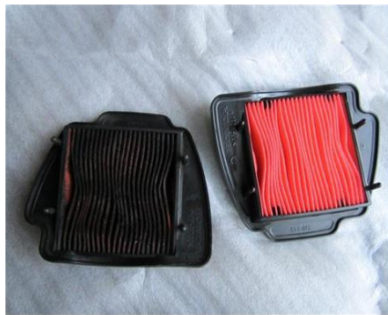
Gambar 8. Saringan udara tipe viscous
