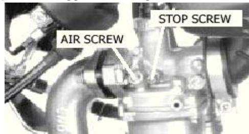
Gambar 15. Posisi Sekrup Penyetel Pada Karburator
